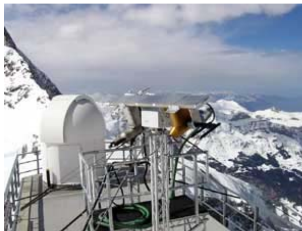
Für die Messkampagne auf dem Jungfraujoch wurden besondere Instrumente eingesetzt; wie der „Cloud Particle Imager“ der Uni Manchester. gross
